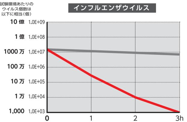
【サンロック工業(株)による ISO 21702 に基づいた試験結果】 ■ 抗ウイルス壁紙 ■ 無加工試験片
